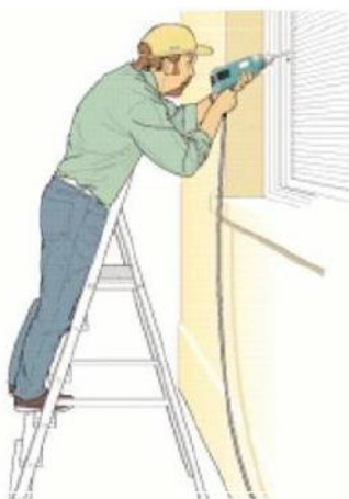
شکل ۱۰- استقرار صحیح برای کار
