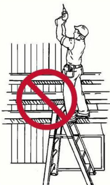
شکل ۱۴- نحوه استقرار غلط برای کار
