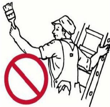
شکل ۱۶- نحوه استقرار غلط بر روی نردبان
