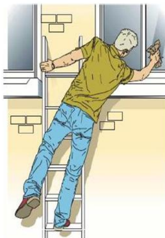
شکل ۱۱- استقرار غلط برای کار
