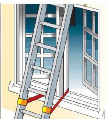
شکل ۸- نحوه تکیه‌گاه فوقانی نردبان یک طرفه
